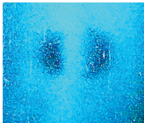
Рис. 5. Фотография флюкс-детектора с изображениями магнитных полей отверстия диаметром 1,0 \cdot 10^{-2} м в пластине из алюминия толщиной 2,0 \cdot 10^{-3} м после воздействия пятью импульсами магнитного поля.
