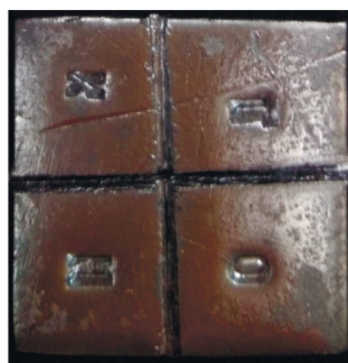
Образец 2: Pb, две перпендикулярные друг другу борозды глубиной 2 и 0,5 мм.
