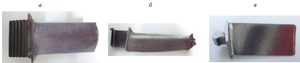
Рис. 4. Вид образцов (лопатки) с естественными дефектами (трещинами и порами) .
