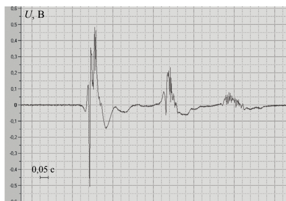
Рис. 5. Дефектограммы плен № 1, 2, 3 (образец № 2).
