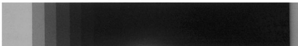
Рис. 2. Набор мер оптической плотности типа НМОП.
