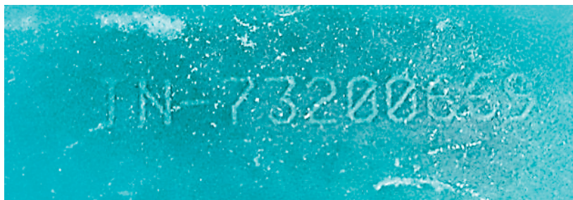
Рис. 6. Увеличенное изображение индикаторного рисунка VIN-кода автомобиля с прикрепившимися к ней вследствие электризации мелкими инородными частицами и с измененным цветовым фоном.
