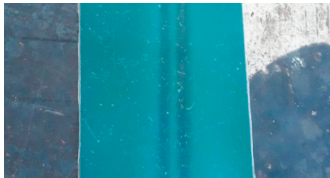
Рис. 8. Индикаторный рисунок на пленке обратной выпуклости шва.
