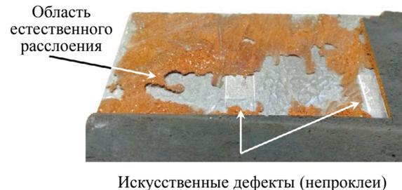
Рис. 8. Зона дефектов D1— D2 после удаления теплозащитного слоя.
