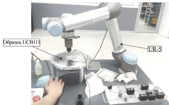
Рис. 7. Роботизированный комплекс для паспортизации преобразователей UR-5 ООО «АКС» и калибровочный полусферический образец.
