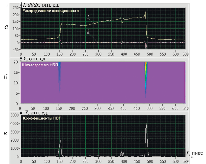
Рис. 4. Обработка изображения щели: а — функция интегрального распределения освещенности и ее производная; б — шкалограмма НВП (Heat); в — кривые коэффициентов НВП (Heat).
