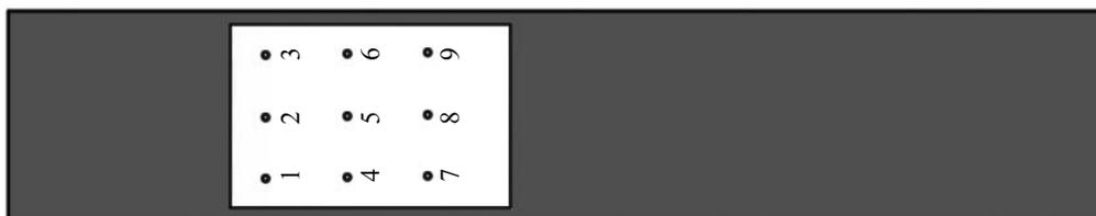
Рис. 1. Расположение девяти контрольных точек измерения параметров вихретокового сигнала на датчике усталости (фольге) испытываемого пластинчатого образца.
