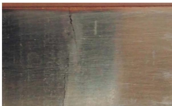
Рис. 6. Фотография стальной пластины (масштаб 1:5) с образовавшейся в ней в ходе усталостных испытаний на изгиб магистральной трещиной вблизи зажима в месте расположения пермаллоевой фольги.
