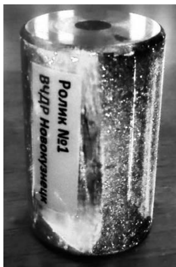
Рис. 2. Трещина в ролике подшипника.
