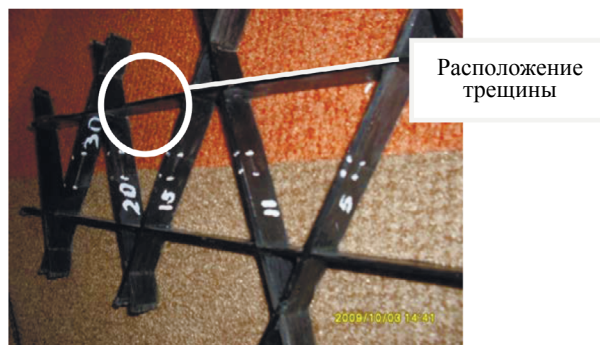
Рис. 6. Фотография фрагмента исследуемого образца (сетчатой конструкции) из КМ.
