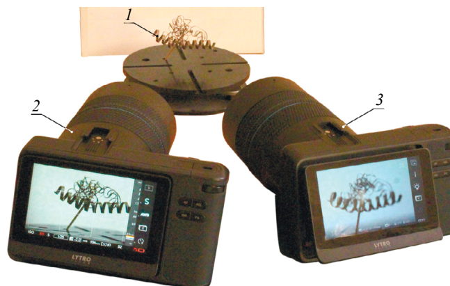
Рис. 6. Фрагмент экспериментальной установки регистрации стружки двумя цифровыми регистраторами СП:
