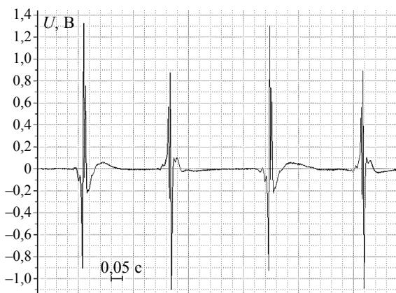
Рис. 6. Дефектограмма от датчика АМРД с зазором 1 мм.
