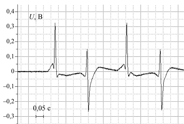
Рис. 7. Дефектограмма от датчика АМРД с зазором 7 мм.
