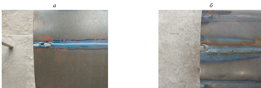
Рис. 3. Прожоги в конце изделия, вызванные перегревом концевой части соединения (материал: сталь 09Г2С): толщина металла 2,0 мм ( I_{\text{св}} = 90\text{ А} , U_{\text{д}} = 16,7\text{ В} , V_{\text{св}} = 20\text{ м/ч} ) (а); толщина металла 4,0 мм ( I_{\text{св}} = 170\text{ А} , U_{\text{д}} = 22,3\text{ В} , V_{\text{св}} = 20\text{ м/ч} ) (б).
