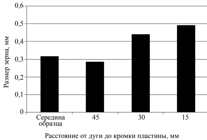
Рис. 4. Изменение размера зерна на участке перегрева при сварке образцов из стали 09Г2С.
