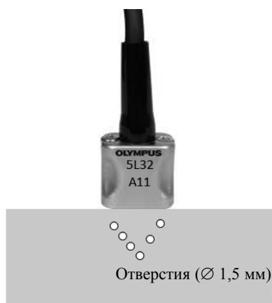
Рис. 5. Образец из нержавеющей стали, датчик и геометрия отверстий.
