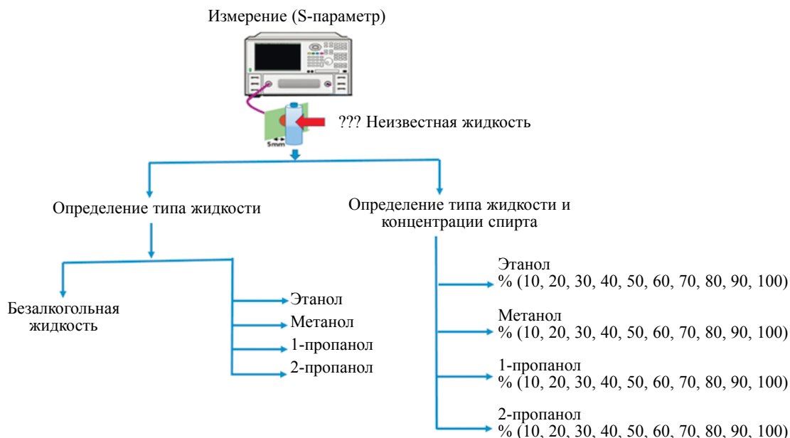
Рис. 3. Принцип метода для классификации типа жидкости и концентрации спирта.
