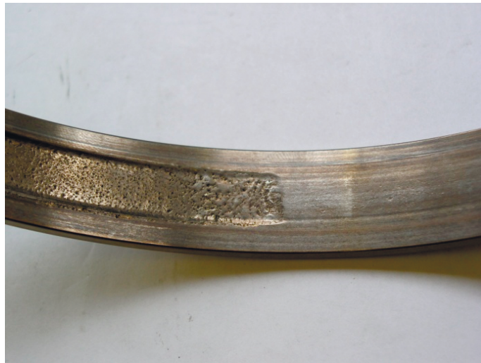
Рис. 7. Питтинг на наружном кольце подшипника опоры ротора.
