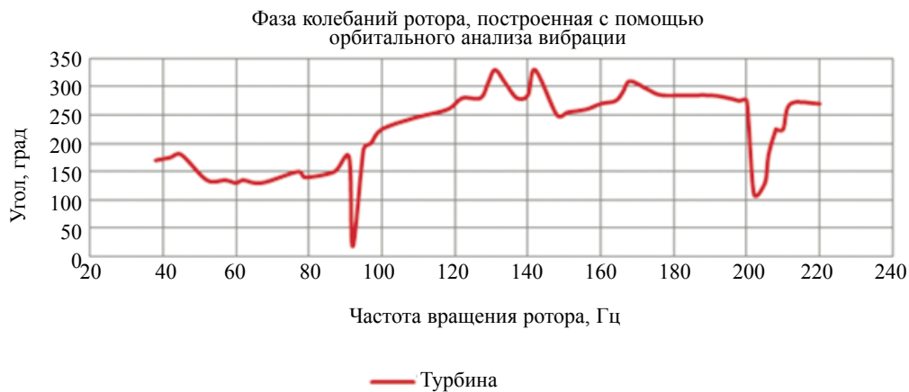
Рис. 6. Фазочастотная характеристика, построенная с помощью орбитального анализа вибрации.
