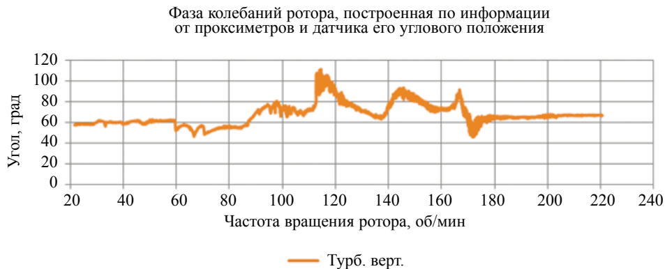
Рис. 5. Фазочастотная характеристика, построенная по сигналам датчика перемещения (проксиметра) и углового положения ротора.
