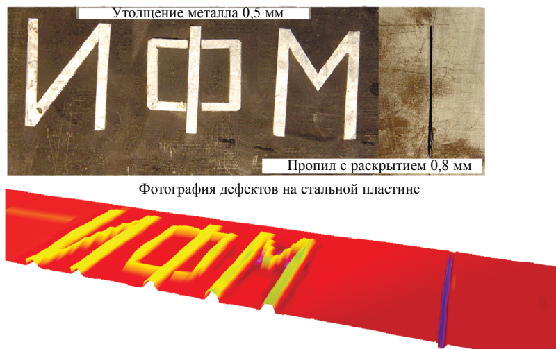
Рис. 6. Фотография ферромагнитной пластины с искусственными неоднородностями и трехмерная реконструкция магнитных неоднородностей по полям рассеяния при нормальном намагничивании пластины.
