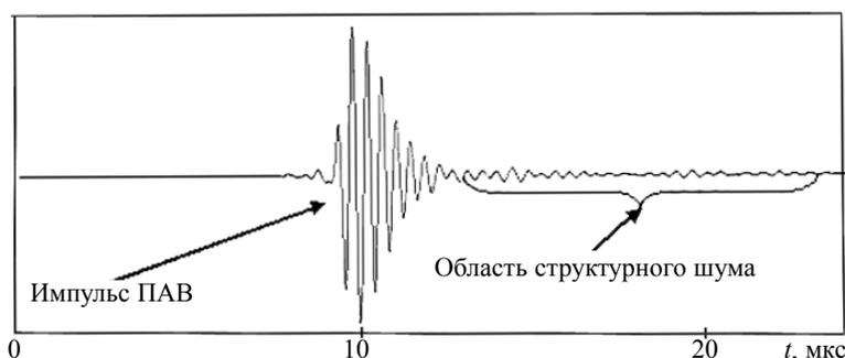
Рис. 3. Оциллограмма сигнала поверхностной волны.
