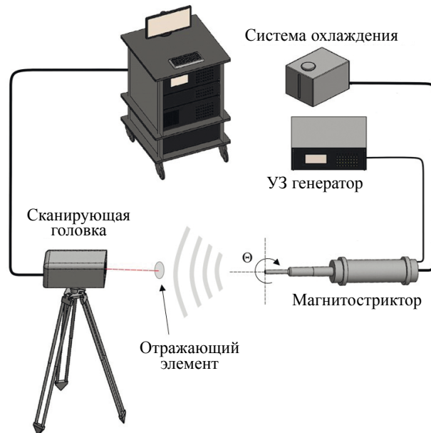
Рис. 2. Схема лабораторной установки для измерения ДН ультразвуковых излучателей с использованием лазерного виброметра.
