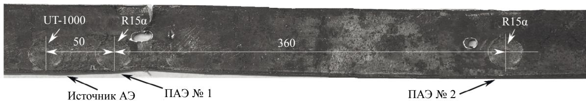
Рис. 7. Вид стальной полосы и мест расположения на ее поверхности источника АЭ (UT-1000) и приемных преобразователей (R15α—SMA).
