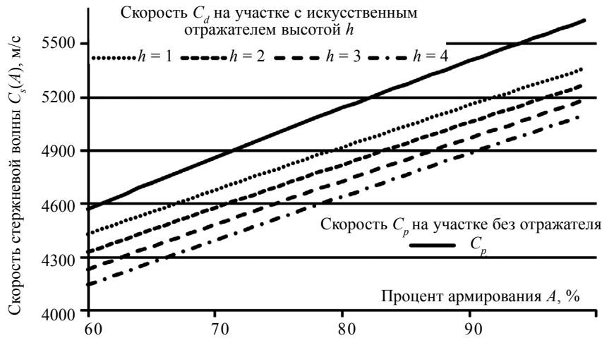
Рис. 2. Скорость стержневой волны в прутке без искусственного отражателя C_p и в зоне с искусственным отражателем C_d при разных высотах дефекта h .
