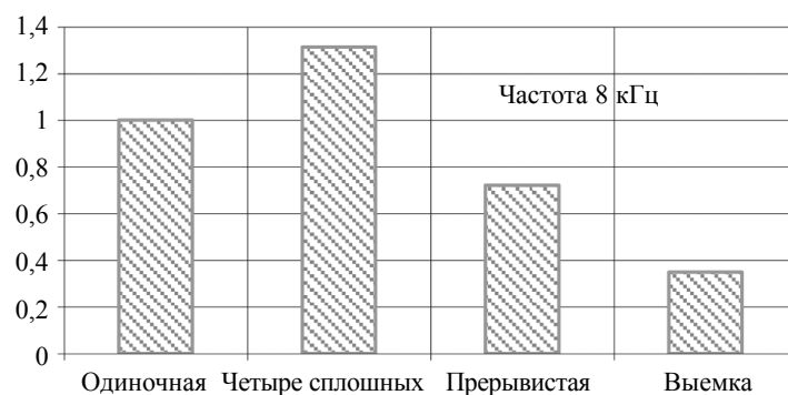
Рис. 18. Сигналы от дефектов с выхода вихретокового преобразователя в сравнении с сигналом от одиночной щели.
