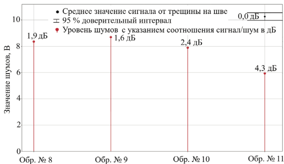
Рис. 6. Уровни шумов на сварных швах, выполненных ручной дуговой сваркой. Внешний вид характерных шумов для таких швов — см. рис. 1 с трещиной № 7.
