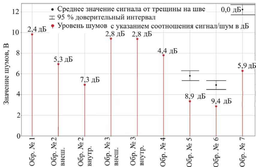
Рис. 5. Уровни шумов на сварных швах, выполненных полуавтоматической сваркой под флюсом, сканирование на образцах № 2 и № 3 выполнялось с внешней и внутренней сторон. Внешний вид характерных шумов для таких швов — см. рис. 1 с трещинами № 4, 5, 6.
