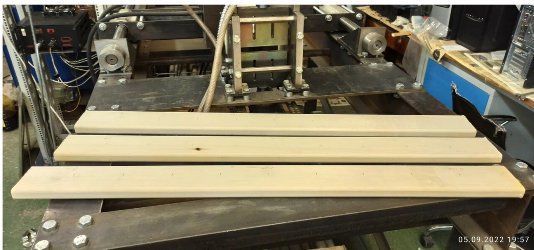
Рис. 1. Исследуемые образцы пиломатериалов перед модулем ультразвуковой обработки.
