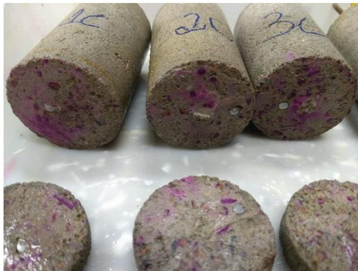
Рис. 4. Образцы, покрытые раствором фенолфталеина.
