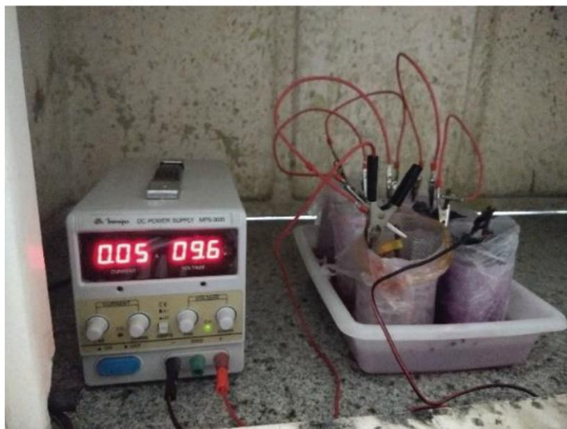
Рис. 3. Система для реалкализации: смесь А — 0,5 А/м<sup>2</sup>.
