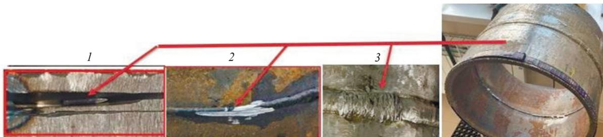
Рис. 1. Изготовление КСС с характерными дефектами: 1 — непровар в корне; 2 — несплавление по разделке; 3 — цепочка внутренних пор.
