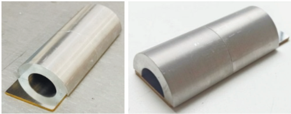
Рис. 4. Вид разборного образца тоннельного типа.
