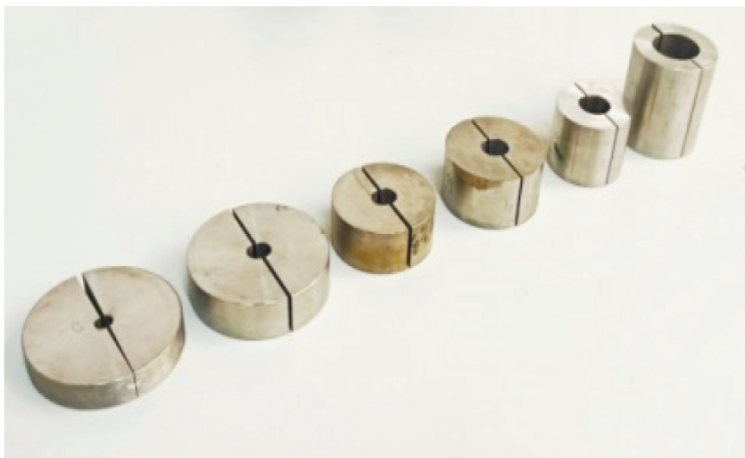
Рис. 9. Вид изготовленных образцов отверстий различного диаметра.
