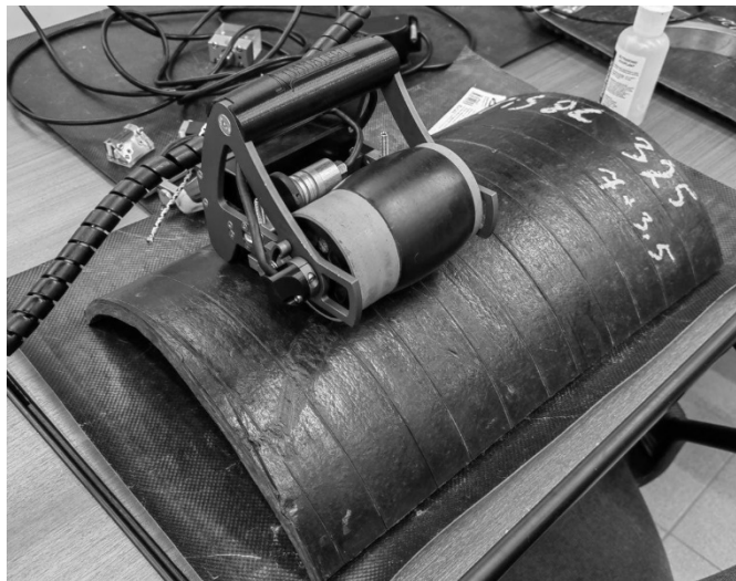
Рис. 1. Роликовый фазированный датчик с матрицей на 64 элемента.
