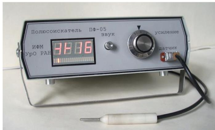
Рис. 6. Медицинский феррозондовый полюсоискатель ПФ-05.
