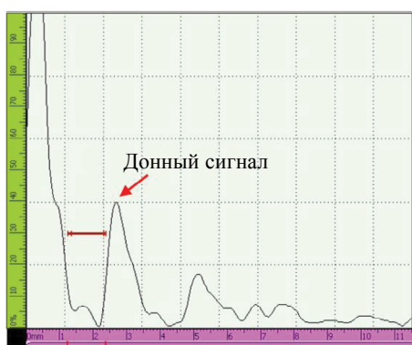
Рис. 8. А-скан, полученный на бездефектном образце.
