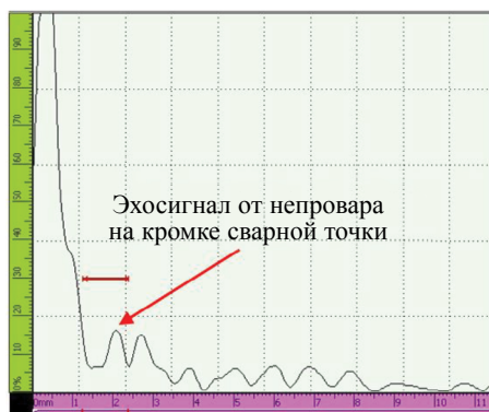
Рис. 10. А-скан, полученный на кромке сварного соединения образца № 2.
