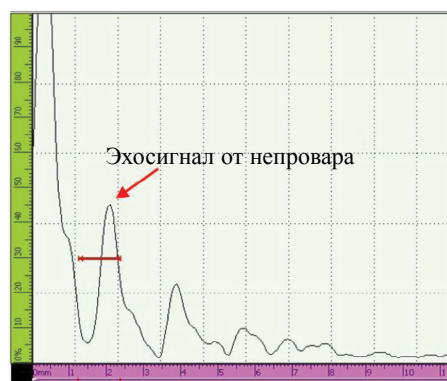
Рис. 9. А-скан, полученный на образце № 1 с непроваром.
