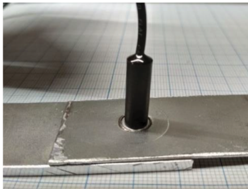
Рис. 6. Общий вид ПЭП для УЗК ТСТП при его установке на экспериментальном образце.
