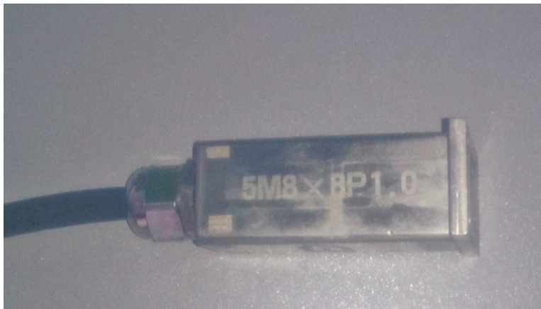
Рис. 2. Ультразвуковая матричная АР Doppler 5M8×8BP1.0.
