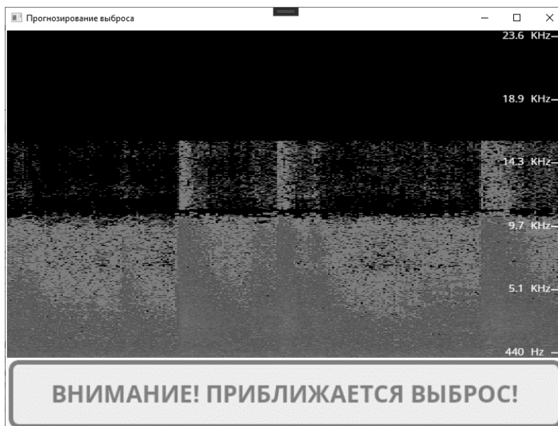
Рис. 8. Интерфейс программы прогнозирования выбросов металла.
