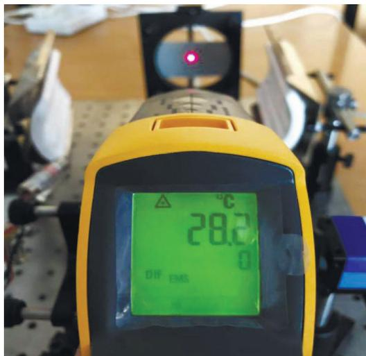
Рис. 5. Использование бесконтактного термометра для исследования температуры образца в любой момент времени.
