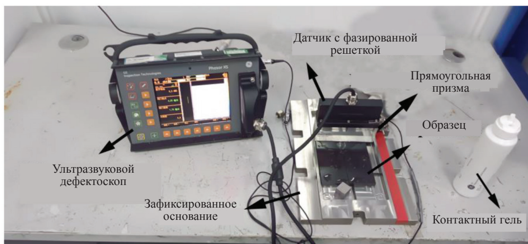
Рис. 3. Установка для ультразвукового контроля фазированными решетками.
