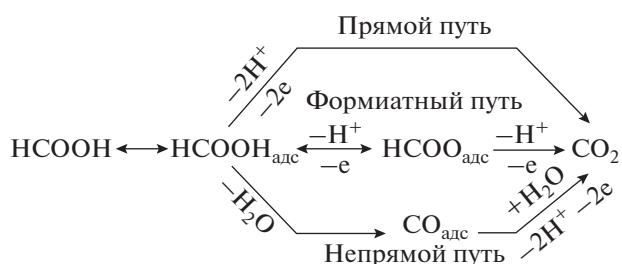
Рис. 10. Трехмаршрутный механизм электроокисления метанола на платине, включающий \text{CO} -маршрут; формиатный маршрут; прямой маршрут с участием слабо адсорбированной молекулы муравьиной кислоты (согласно [152]).
