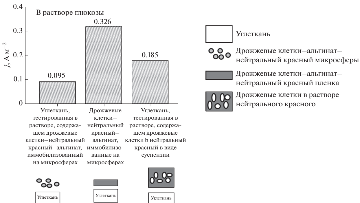
Рис. 5. Плотность тока, генерированного на электродах из углеткани в 0.1 М растворе глюкозы; фосфатный буферный раствор, рН 7. Приложенный потенциал: 0.3 В (нас. к. э.); Pt-противоэлектрод. Концентрации дрожжевых клеток и нейтрального красного, соответственно, 2 г/100 и 10 мМ.
