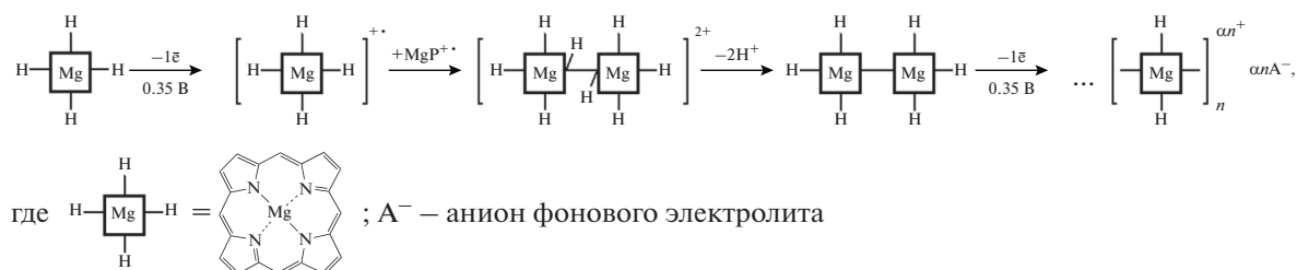
Рис. 1. Схема образования полимера в процессе электрополимеризации порфина магния.
