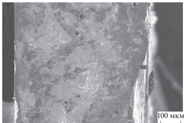
Рис. 10. Электронная микрофотография поперечного скола таблетки \text{CsAg}_4\text{Br}_{2.5}\text{I}_{2.5} .
