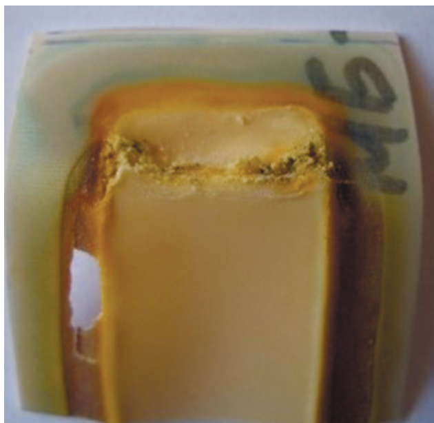
Рис. 6. Разрыв МБ-2 при БЭД.
