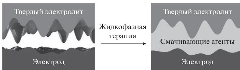
Рис. 1. “Жидкофазная терапия” контакта твердый электролит/электрод [26].
