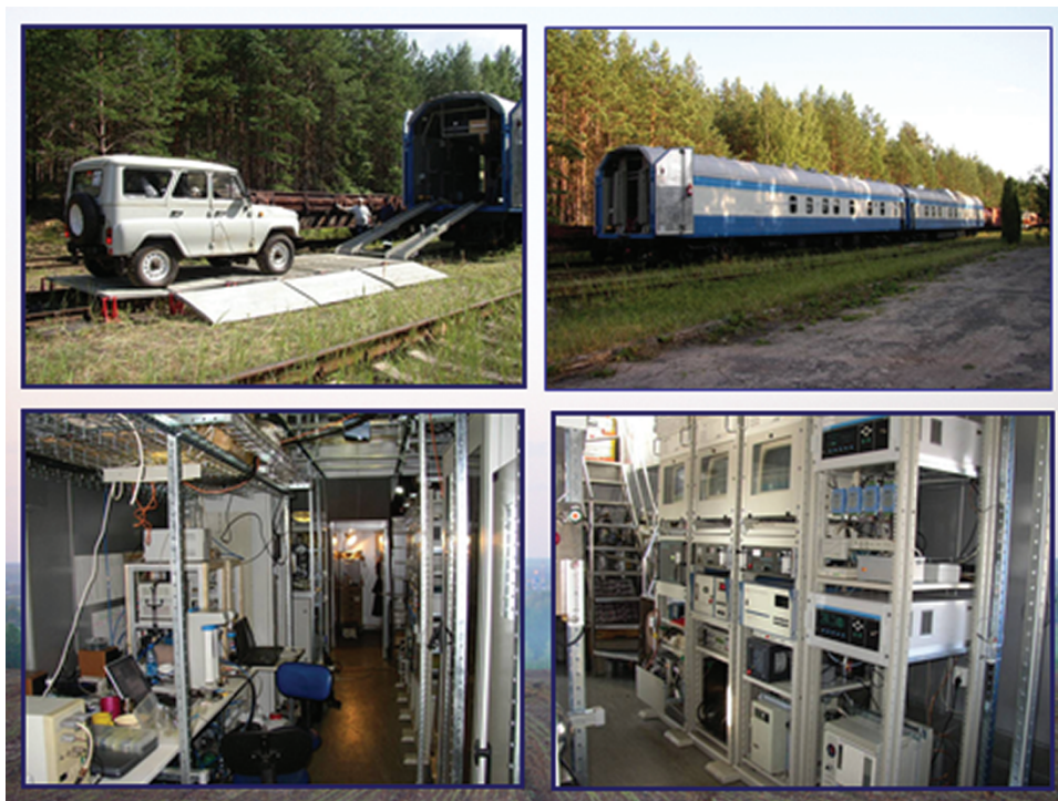
Рис. 1. Передвижная лаборатория TROICA в полном составе (из 2 вагонов) (вверху). Внутренний вид вагона-обсерватории с автоматизированным комплексом для измерения состава атмосферы (внизу).
