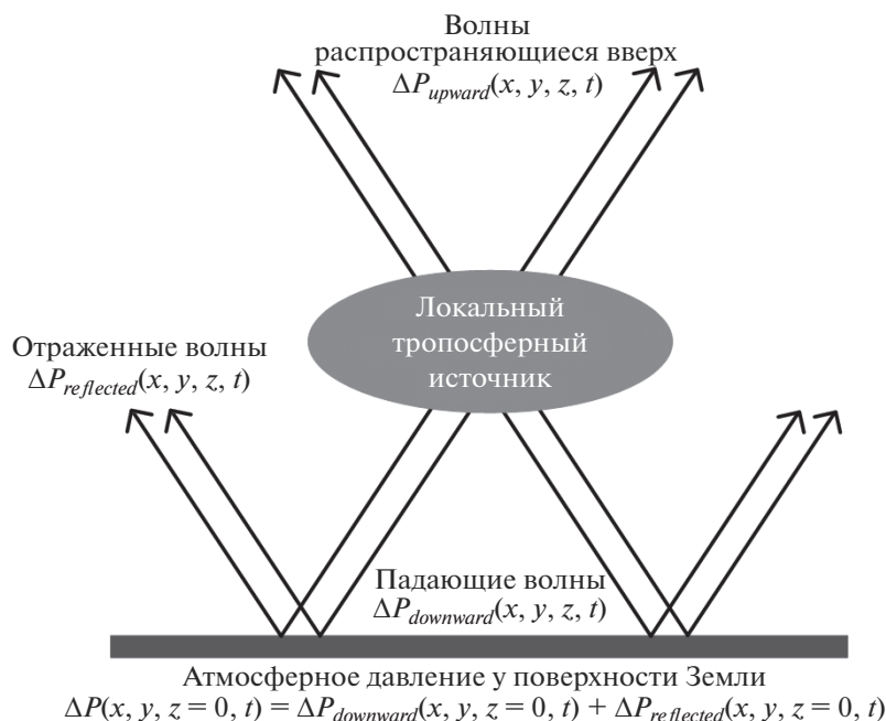
Рис. 1. Схематическая картина распространения волн от тропосферного источника тепла.
