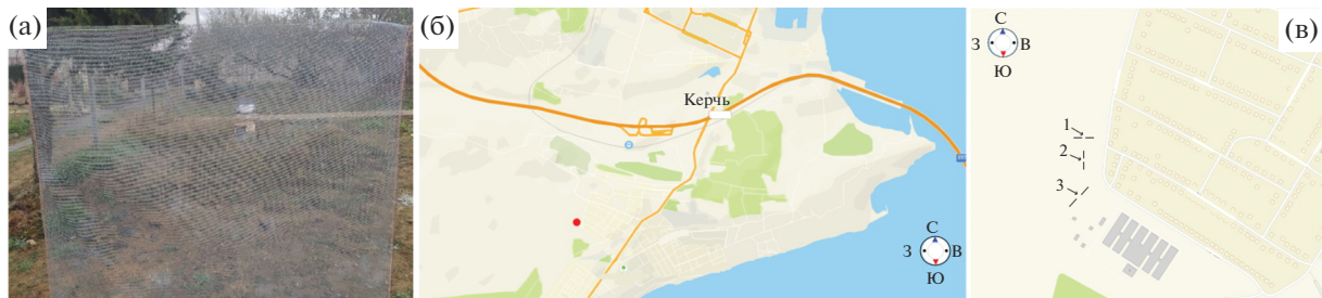
Рис. 1. Стандартный коллектор тумана (а), размещение полевой базы (б), схема ориентации сеток (в).
