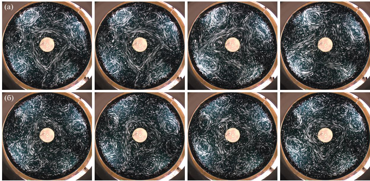
**Рис. 8.** (а) Траектории частиц в канале (изображения через равные промежутки времени  $\Delta\tau = \frac{10}{24}T$ ) в эксперименте при периоде вращения установки  $T = 42.1$  с и токе  $j = 400$  мА на электродах 1 и 3 (см. рис. 7); (б) при периоде вращения установки  $T = 30.8$  с при токе  $j = 0$  на электроде 3 и токе  $j = 400$  мА на электроде 1 (на (а, б) – эксперименты с неодимовыми магнитами на трех окружностях).
