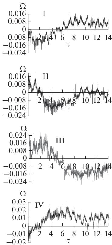
**Рис. 10.** Средние по секторам I–IV завихренности в эксперименте с аномальным расположением постоянных магнитов ( $\tau = t/T$ ,  $T = 21.2$  с).
