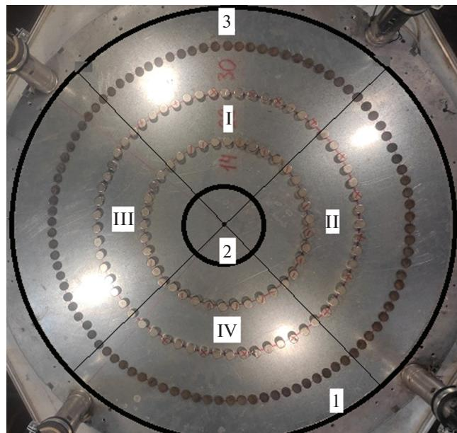
Рис. 7. Схема расположения электродов 2, 1, 3, постоянных магнитов и деление на секторы I–IV для рис. 9, 10 в канале лабораторной установки.
