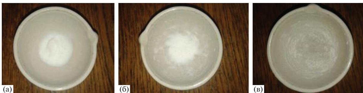
Рис. 1. Фотографии изменения внешнего вида метилкремнезема (или композита МК/ЯК) при высоких механических нагрузках.
