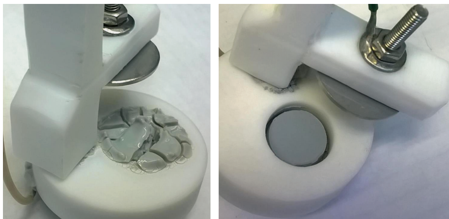
Рис. 3. Компакты (после сушки) при ЭФО из суспензии нанопорошка А2 при напряжении 100 В, образец А2_10 (слева) и 20 В, образец А2_13 (справа).
