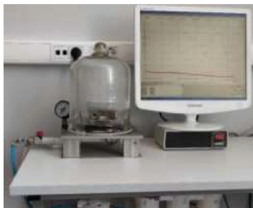
Рис. 1. Схема и фото вакуумного гравиметрического анализатора: 1 – вакуумный насос, 2 – система осушки атмосферного воздуха, 3 – манометр, 4 – термостатируемые весы, 5 – стеклянный купол прибора, 6 – управляющий компьютер, 7 – цифровой терморегулятор.
