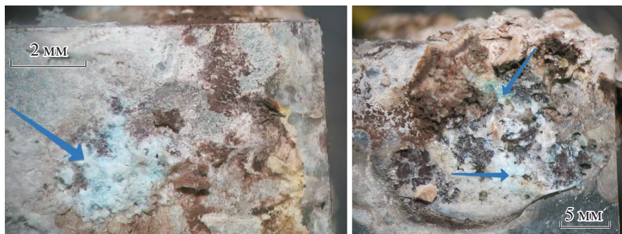
Рис. 10. Продукты коррозии меди на поверхности образца (стрелками показана локализация продуктов коррозии меди).
